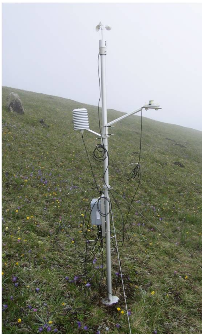
Рис. 2. Метеорологическая станция MiniMet
