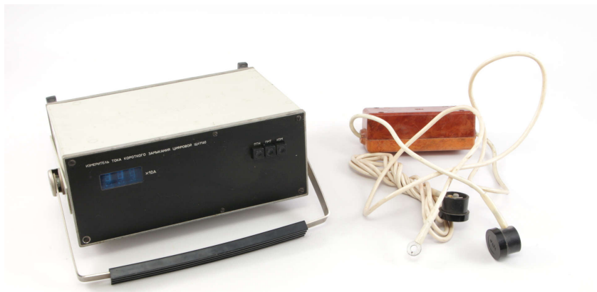
Рисунок 30 Измеритель тока короткого замыкания Щ41160. Произведён в СССР
