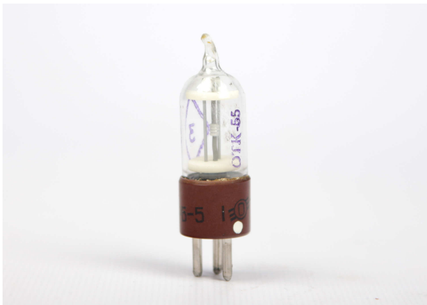
Рисунок 92 Разрядник РБ-5 производства СССР.
