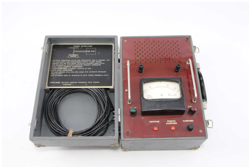
Рисунок 29 Измеритель сопротивления петли фаза-ноль М417. Производства СССР
