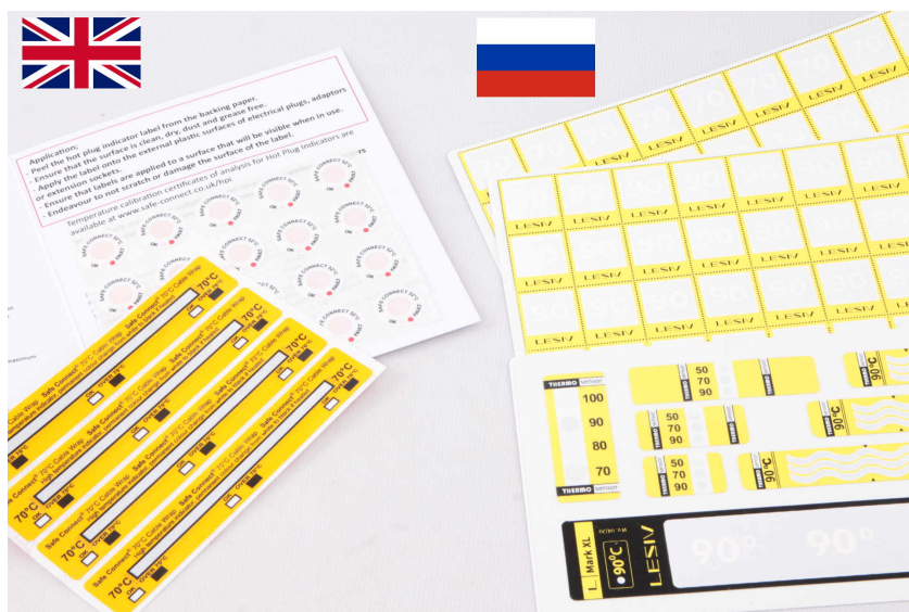
Рисунок 63 Наклейки – термоиндикаторы отечественного и британского производства. Температура срабатывания круглых британских наклеек 52°C, полосковых британских 70°C. У отечественных – точки с температурами срабатывания 50°C, 70°C, 80°C, 90°C, 100°C, квадратные на 70°C и 90°C, полосковые на 90°C. Набор возможных температур индикаторов плавления весьма широк, я встречал варианты наклеек от 29°C до 290°C
