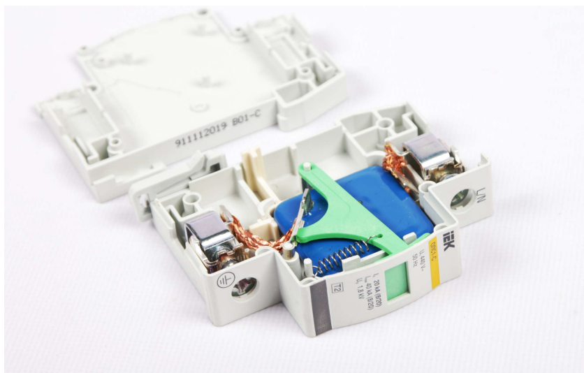
Рисунок 96 Внутренности ограничителя перенапряжений ОПС-1 от компании IEK.
